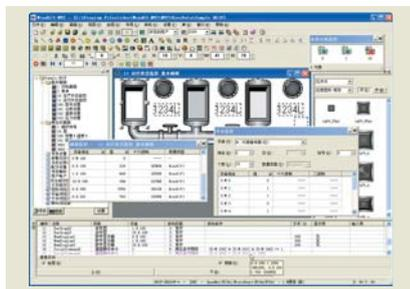
标配在WindO/I-NV2画面上可进行确认的「预览功能」、与HG1F型连接后进行确认的「模拟功能」、与HG1F型及主机连接后进行确认的「调试功能」以及充实的「测试功能」。可通过「总监控」或「画面监控」在监控设备的同时，进行包括部件的设定条件的画面编辑，方便的操作性能提高工作效率。
