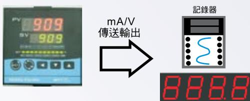
外部裝置可藉由此功能，獲取PV或SV數值。傳送信號類別：0-20mA, 4-20mA, 0-5V, 0-10V, 1-5V, 2-10V
