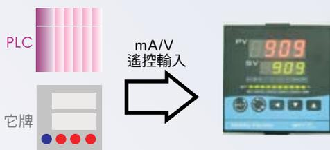
外部裝置可藉由本功能，遙控SV設定值。遙控輸入信號類別：0-20mA, 4-20mA, 0-5V, 0-10V, 1-5V, 2-10V
