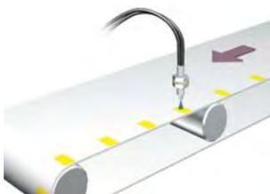
使用 RGB 比例判別的方式，故檢測時不受工件的距離變化所影響
