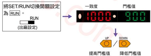
\*使用「切換顯示」功能來變更顯示方法時，只要操作按鍵即可將副顯示區切換為門檻值顯示。
