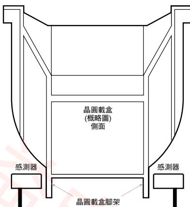
使用時請將感測器設置於下圖有○符號的4個轉角部位。
