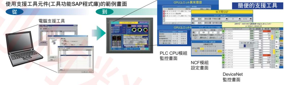
CPU匯流排模組及特殊I/O模組的故障排除也可以透過SAP程式庫來執行。有一個故障排除精靈SAP程式庫可以用來進行PLC中各模組的故障排除。當有一個模組發生錯誤時，故障排除精靈SAP程式庫會提供一個簡明易懂的錯誤原因解說以及相關的因應對策。
