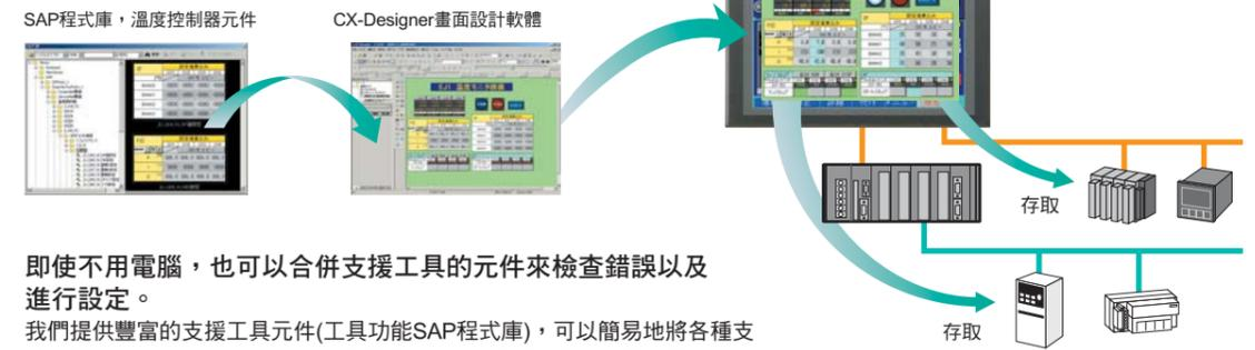
即使不用電腦，也可以合併支援工具的元件來檢查錯誤以及進行設定。我們提供豐富的支援工具元件(工具功能SAP程式庫)，可以簡易地將各種支援工具功能合併到NS系列PT中，只需要將支援工具元件貼到畫面上即可，即使沒有電腦，也可以檢查是錯誤及進行設定。
