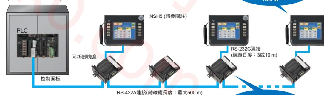
註：在從可拆卸機盒上拆下NSH5之前，請務必先關閉可拆卸機盒上的電源鑰匙開關。
