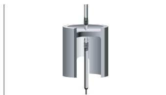
引擎零件的加工尺寸測量 ZX-TDS01/TDS04型符合IP67標準，即使置放於會潑濺到水的環境下，也能安心使用。
