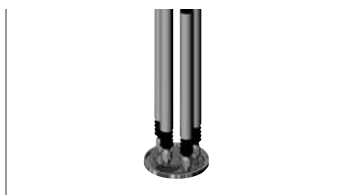
時鐘之組裝高度的測量 可緊密安裝，因此能夠用來確認小型零件的高度差。
