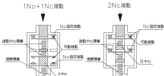
NC接點的強制脫離機構,作用是當接點發生熔著時,下壓鑰匙機構中心時,可將接點強制推開,使回路切斷。
