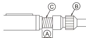
將B鎖到C底部(A處為零間隙), 固定時用手旋緊, 請勿用鉗子。
