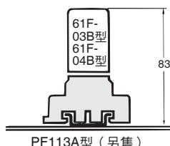
安裝於正面連接插座PF113A型時，請使用PFC-A1型。
