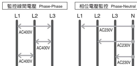
僅需1台即可監控全球的三相電壓電源狀況
