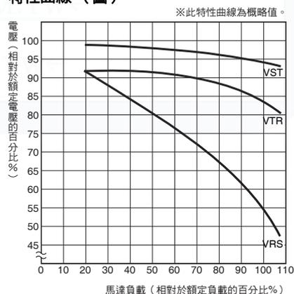
註: 此圖為 R 相欠相的狀態。VST、VTR、VRS 表示欠相時馬達端子的電壓。
